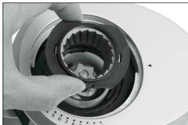
Разберите перемалывающий блок: Извлеките корпус жерновов из перемалывающего блока.
